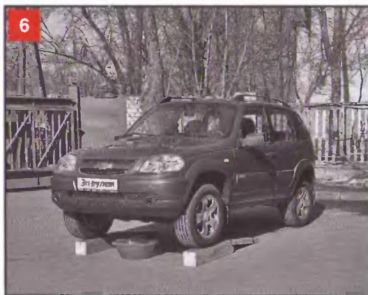
Устанавливаем под двигатель широкую емкость объемом не менее 5 литров
