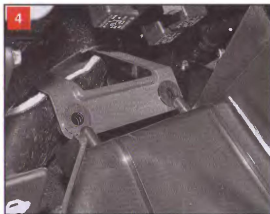
4 Выводим крепежные выступы в нижней части крышки из резиновых втулок в отверстиях крепления (это может потребовать усилия)
