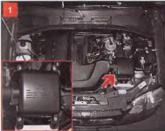
Корпус воздушного фильтра расположен с левой стороны моторного отсека
