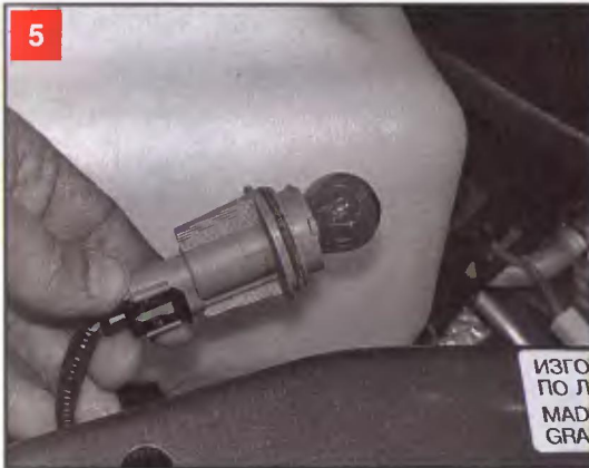
5 Повернув патрон лампы указателя поворота против часовой стрелки, вынимаем его из корпуса фары
