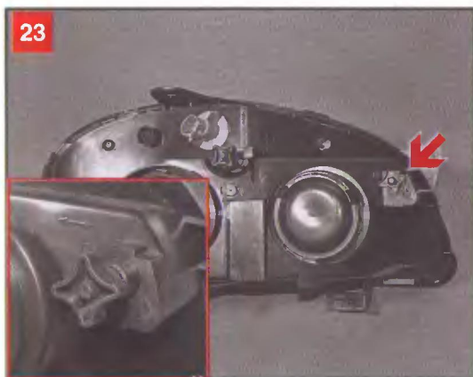
Расположение ручки регулировочного винта, смещающего световой пучок ближнего света фары вправо или влево
