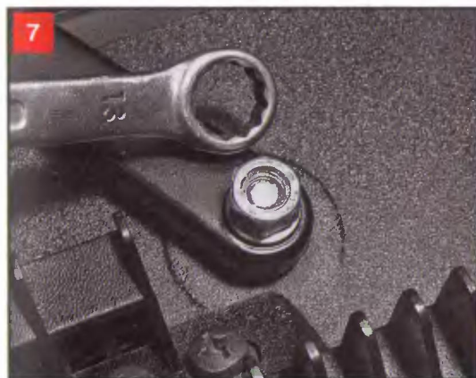
Ключом «на 13» отворачиваем гайку крепления рычага
