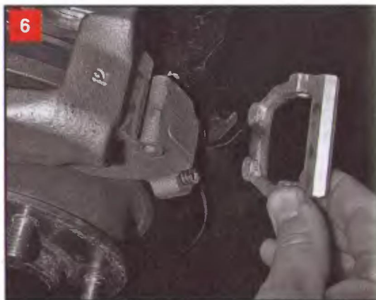
6 Снимаем нижний прижимной рычаг. Под ним в отверстиях направляющей колодок установлены две пружинки
