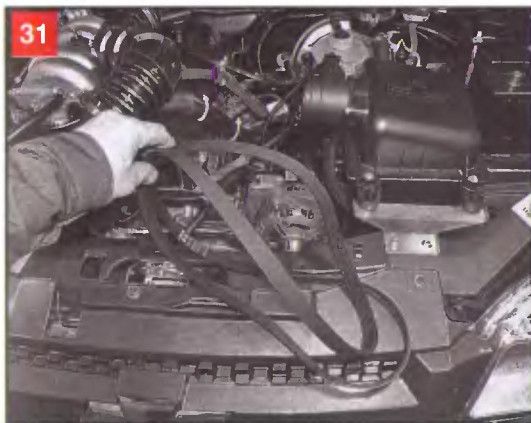
Сняв ремень привода с остальных шкивов, вынимаем его из моторного отсека
