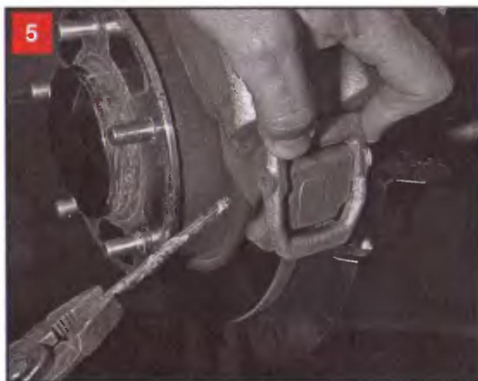
5 Вытягиваем ось пассатижами, придерживая нижний прижимной рычаг
