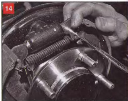
Используя отвертку как рычаг и опираясь ею о ступицу колеса, отводим переднюю колодку в сторону и на себя так, чтобы ее носок вышел из прорези поршня тормозного цилиндра
