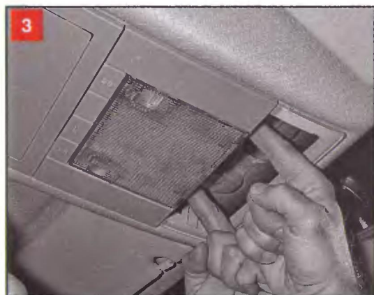
3 Нажимаем двумя пальцами на фиксаторы рассеивателя
