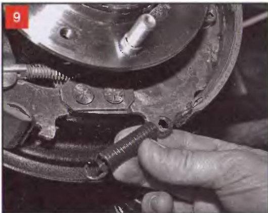
9 Снимаем нижнюю стяжную пружину
