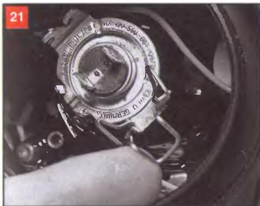
Отводим фиксатор вниз. Вынимаем лампу ближнего света из корпуса фары за выступающие контакты
