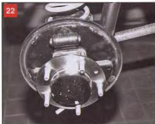
Вид на тормозной щит заднего тормоза с цилиндром при снятых колодках
