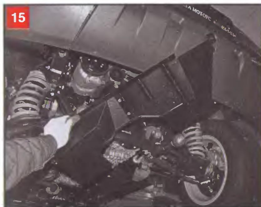
15 При необходимости можно снять передний брызговик двигателя целиком, не отворачивая саморезы, скрепляющие его части (см. фото 12). Но в этом случае потребуется отвернуть еще два самореза крепления левой части брызговика
