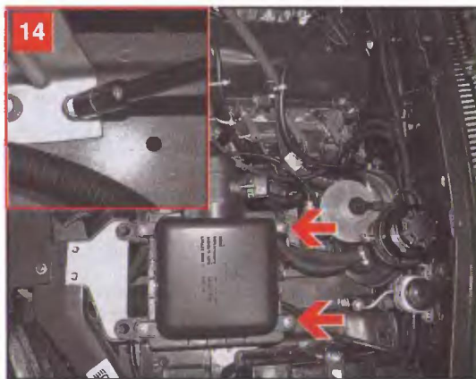
Ключом или головкой «на 10» отворачиваем два болта заднего крепления корпуса воздушного фильтра (к левому лонжерону кузова)
