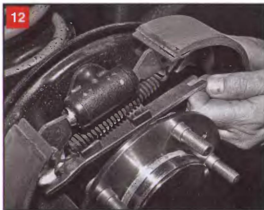
12 Опираясь носком колодки на поршень тормозного цилиндра (не повредите резиновый пыльник) и преодолевая сопротивление пружины, поднимаем колодку за ее нижнюю часть и выводим распорную планку из прорезей колодок
