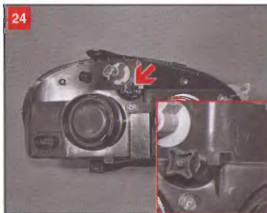
Расположение ручки регулировочного винта, смещающего световой пучок ближнего света фары вверх или вниз
