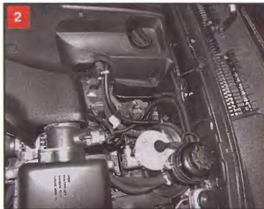
2 Для доступа к свечам необходимо снять экран двигателя
