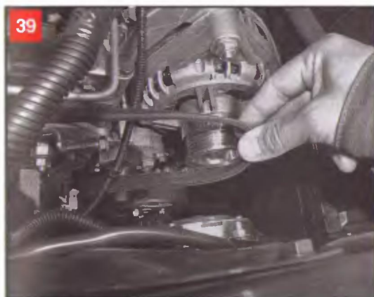
39 Надеваем ремень рабочей стороной на шкив генератора и натягиваем его с помощью натяжного устройства
