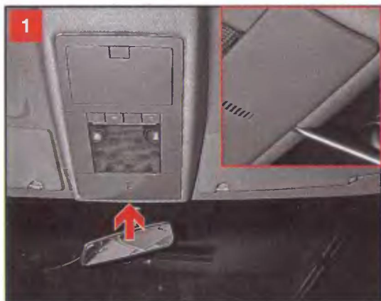
1 Концом плоской отвертки поддеваем крышку плафона
