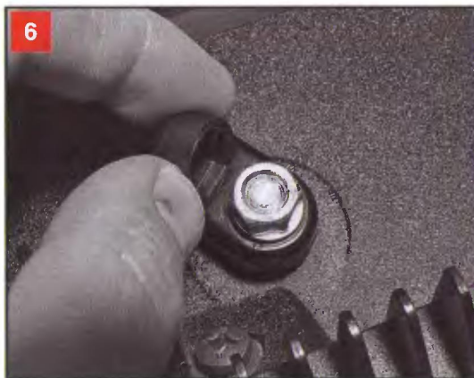
Снимаем защитный колпачок с гайки правого рычага стеклоочистителя
