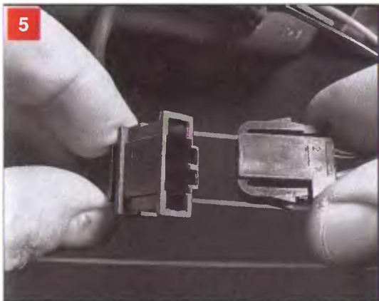
Отсоединяем колодку проводов от разъема фонаря
