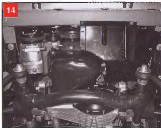
14 Вид снизу на приводной ремень компрессора кондиционера при снятой правой части переднего брызговика двигателя
