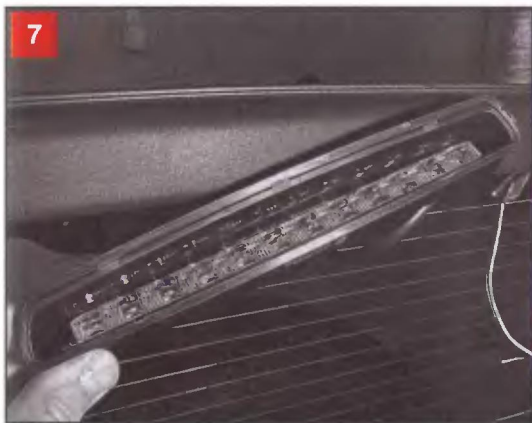
Внутри корпуса фонаря расположен блок светодиодов
