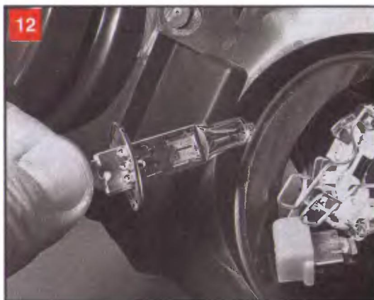
12 Вынимаем лампу дальнего света из корпуса фары, удерживая ее за контакт. Новую лампу и снятые детали устанавливаем в обратной последовательности
