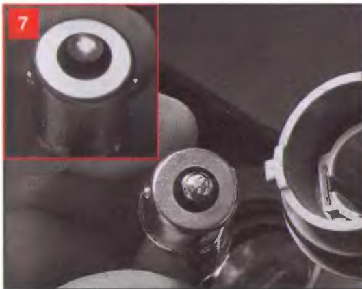
7 Утапливаем лампу в патрон, затем поворачиваем ее пальцами за колбу против часовой стрелки и вынимаем из патрона. Новую лампу и снятые детали устанавливаем в обратной последовательности
