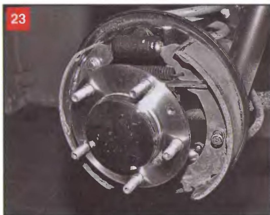
Устанавливаем колодки и снятые детали в обратной последовательности. Последней устанавливаем на свое место нижнюю стяжную пружину тормозных колодок
