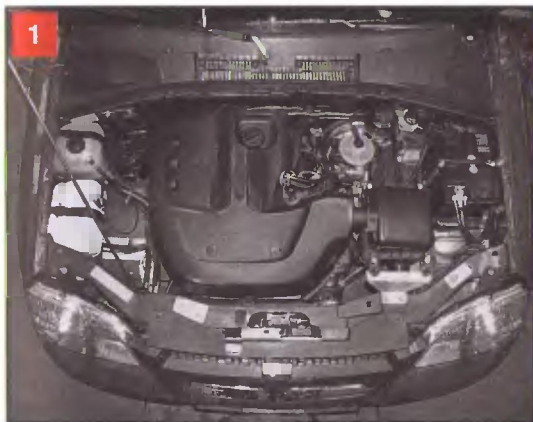
1 Свечи зажигания ввернуты в головку блока цилиндров двигателя с левой стороны (по ходу автомобиля)
