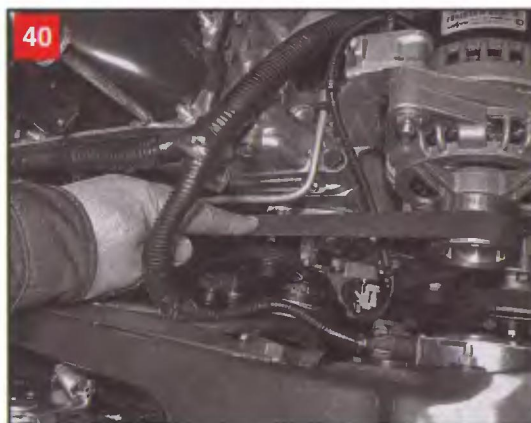
40 Проверяем натяжение ремня, прогибая середину наиболее длинного его участка (от шкива насоса охлаждающей жидкости до шкива генератора)
