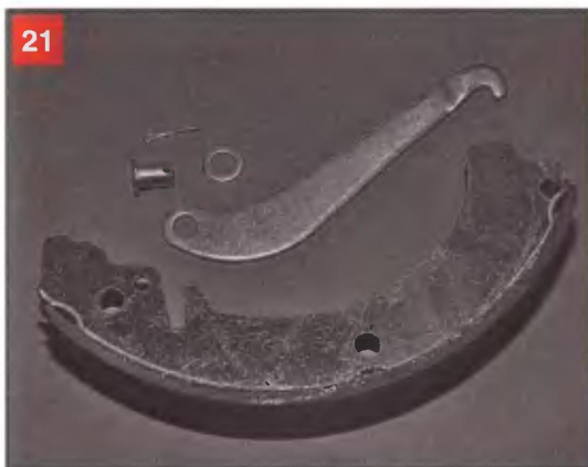
Задняя колодка с рычагом, шайбой, осью рычага и шплинтом. Колодки заднего тормоза одинаковы, рычаг привода ручного тормоза можно присоединить к любой из них
