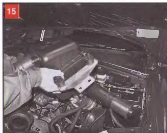
Отводим корпус воздушного фильтра назад и, приподняв, вынимаем его из моторного отсека
