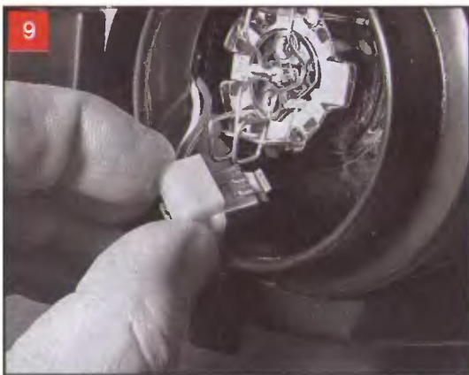
9 Снимаем колодку проводов с контакта лампы
