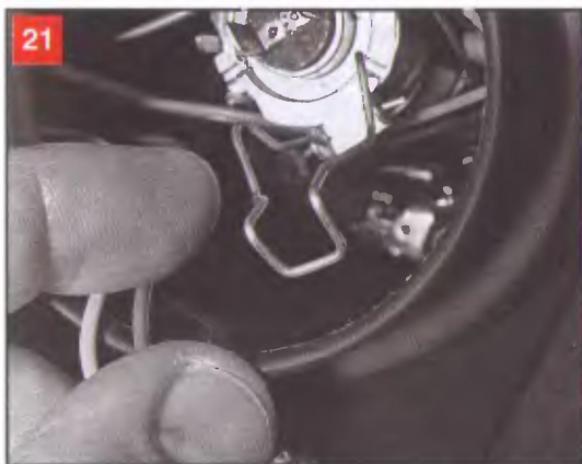
Отводим фиксатор вниз. Вынимаем лампу ближнего света из корпуса фары, удерживая ее за выступающие контакты
