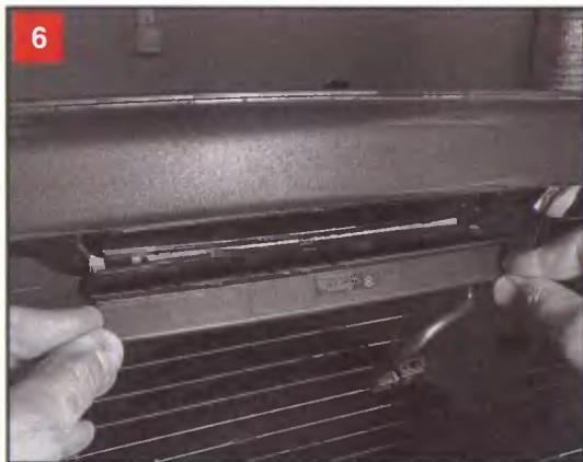
Преодолевая сопротивление пластмассовых защелок, отсоединяем корпус фонаря от его рассеивателя движением сверху вниз (рассеиватель остается приклеенным к стеклу)
