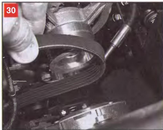
Удобнее начать снятие ремня со шкива генератора (как наименьшего по диаметру)
