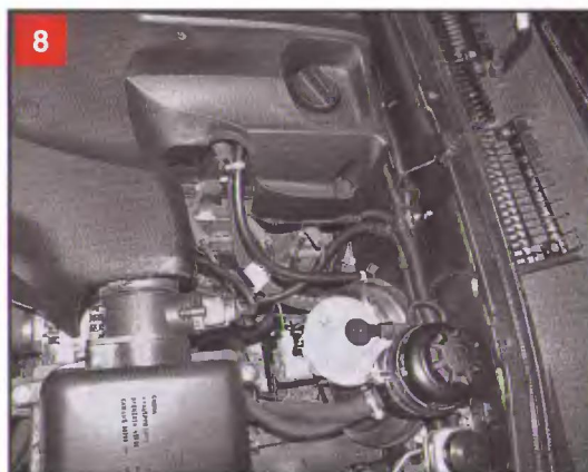
Для доступа к масляному фильтру снимаем экран двигателя и корпус воздушного фильтра (см. «Фильтр воздушный»)
