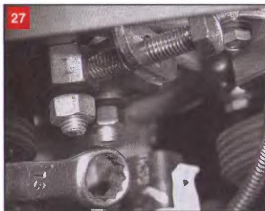
Для регулировки натяжения, а также для снятия ремня накидным ключом «на 13» ослабляем затяжку трех гаек натяжного устройства. Две гайки видны на данном фото, третью гайку отворачиваем головкой «на 13» (показана стрелкой на фото 25)
