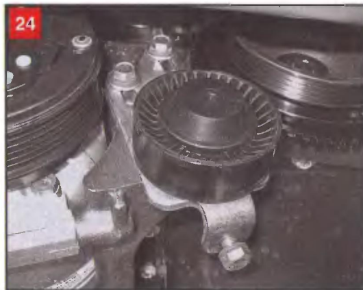
Вид на привод компрессора кондиционера при снятом ремне
