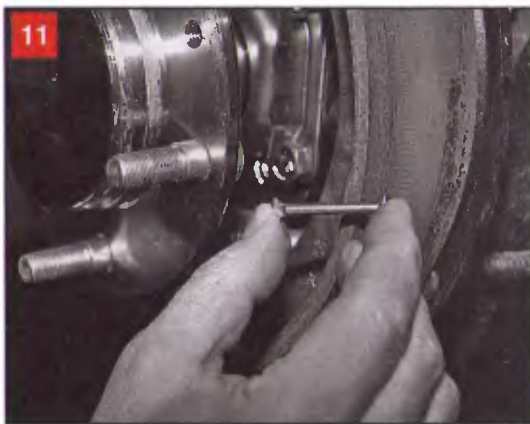
11 Снимаем опорную стойку передней колодки, нажимая на ее хвостовик и выводя ее из отверстий в колодке и тормозном щите в сторону автомобиля
