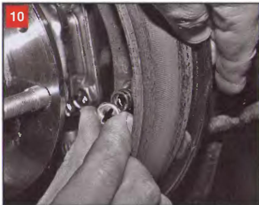
10 Нажимаем и поворачиваем фиксирующую чашку пружины опорной стойки передней колодки. Совмещаем прорезь на чашке с плоскостью хвостовика стойки и снимаем фиксирующую чашку, пружину и расположенную под пружиной опорную чашку
