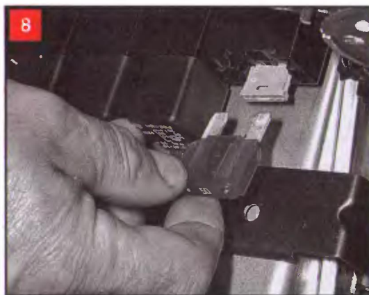
8 Предохранители большого размера вынимаем из блока рукой. Предохранители меньшего размера вынимаем пинцетом-съемником (см. «Предохранители монтажный блок»)
