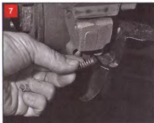
7 Вынимаем пружинки прижимного рычага, чтобы не потерять их
