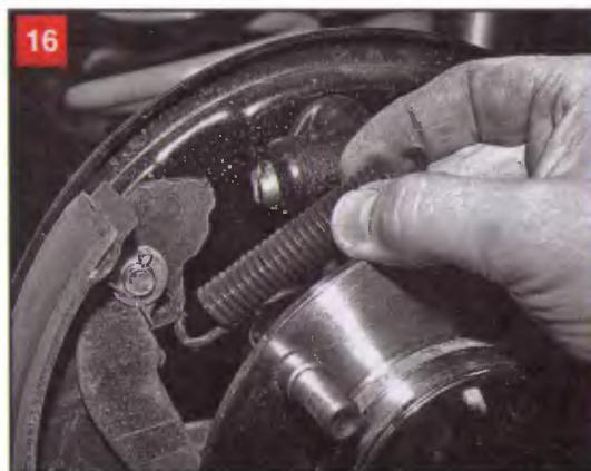
Выводим второй крючок верхней стяжной пружины из отверстия в задней колодке и снимаем пружину
