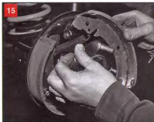
Снимаем переднюю колодку, выводя крючок стяжной пружины из отверстия в ней
