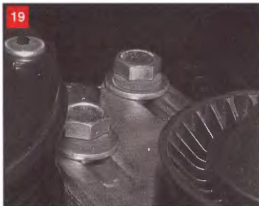
19 Фиксирующие болты пластины натяжного устройства ремня привода кондиционера (показаны при снятом ремне)
