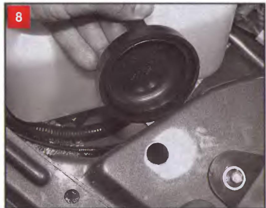
8 Для доступа к лампе дальнего света снимаем резиновую защитную крышку, расположенную с обратной стороны фары слева (глядя по ходу автомобиля)
