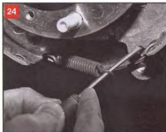
Для установки нижней пружины, работая стержнем отвертки как рычагом, заводим крючок пружины за выступ в нижней части колодки
